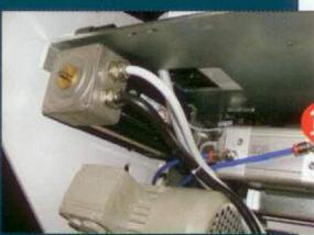
L'impiego di un motore Brushless permette di regolare la velocità di avanzamento e la spinta ai valori ottimali in ogni momento del ciclo di lavoro.
