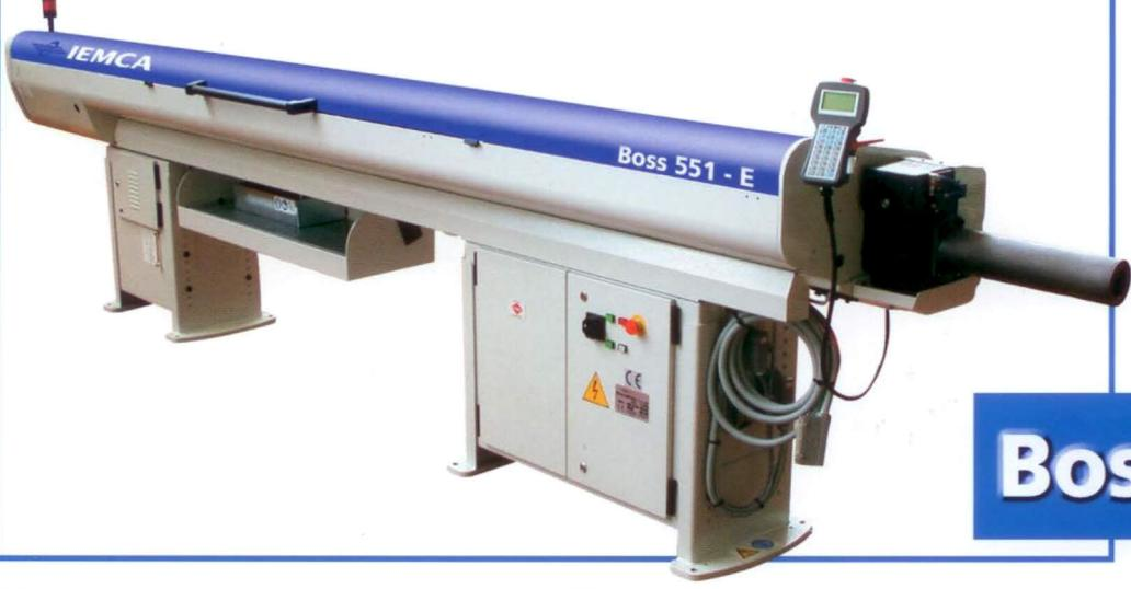
Caricatore automatico per barre di diametro da 3 a 32 mm (Boss 332) ideale per torni a fantina mobile; da 5 a 45 mm (Boss 545) e da 5 a 51 mm (Boss 551) ideali per torni a fantina fissa; di lunghezza da 3200 a 4400 mm; configurabile con la totalità dei torni esistenti sul mercato
